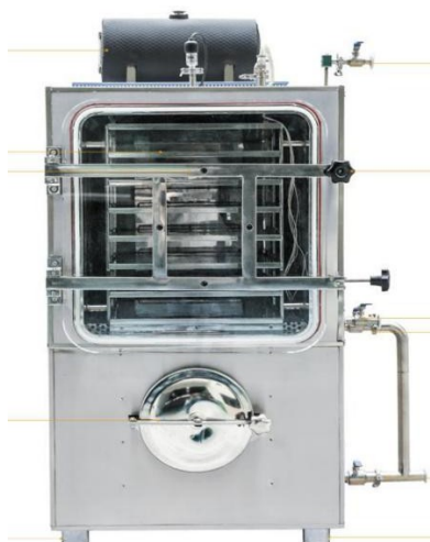
Сурет 12 – ZLGJ-300 үлгісіндегі сөрелі типтегі вакуумдық сублимациялық кептіру қондырғысы
